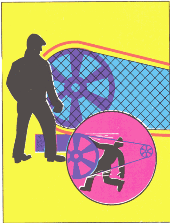
Phải có lưới che chắn an toàn Dây đai truyền
